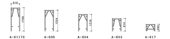
914枠を使用時、階段部に1219枠を
